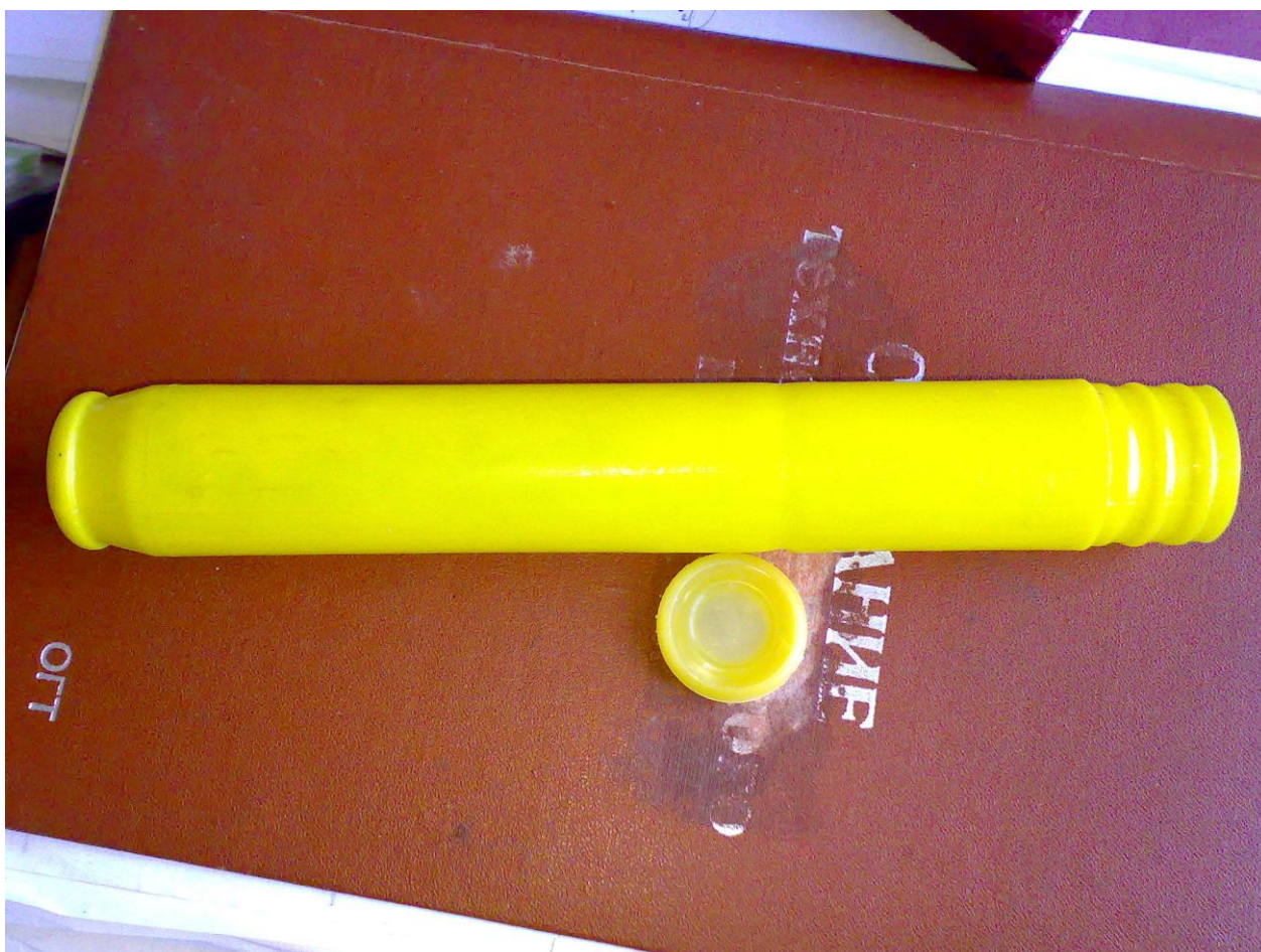
Рис. 1. Герметичный патрон угленита в полиэтиленовой оболочке
